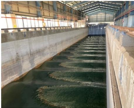
圖6 大型斷面試驗水槽
