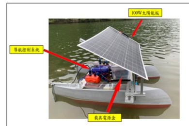
圖 4 雙體船之船體製及酬載配置規劃圖
