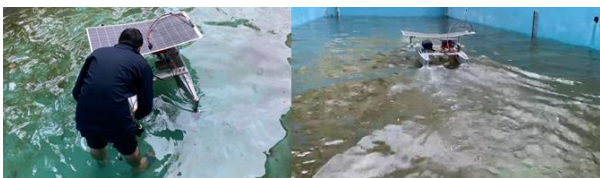
圖 6 小型水面載具於水槽中高速(速率約 5 節)前進測試
