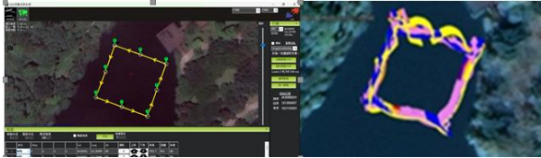
圖 9 設定方形航行巡航點示意及航行動態測試軌跡圖
