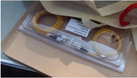
圖 12. 實驗用 FBG 應變感測器
