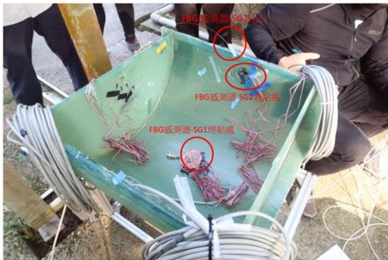
圖 16. FBG 感測器完成架設
