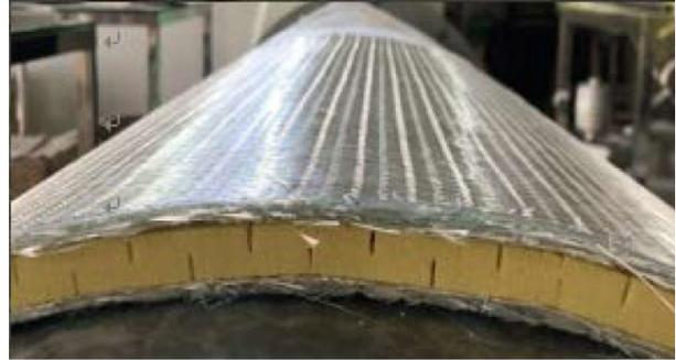
圖 13. FRP 結構纖維鋪設方式
