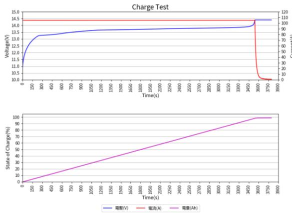
圖2：乾熱試驗下充電測試曲線
