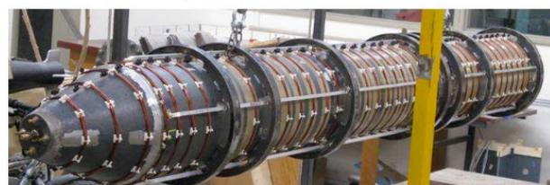
圖 13 潛艦消磁線圈模擬配置圖
