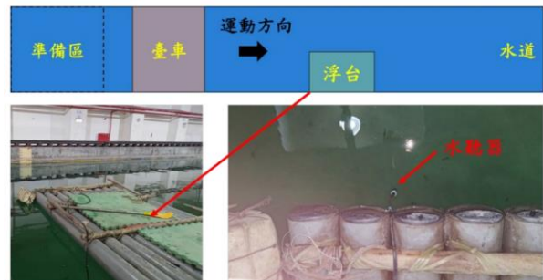
圖 12 水槽臺車工作噪音量測方式
