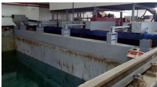
圖 7 拖航水槽-造波機
