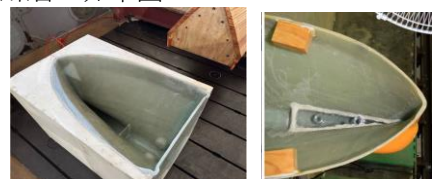
圖 4 聲納球艙 FRP 模型積層過程
