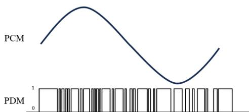
圖 18、PCM 訊號與 PDM 訊號示意圖
