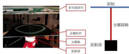
圖 17、振動器與金屬薄板配置
