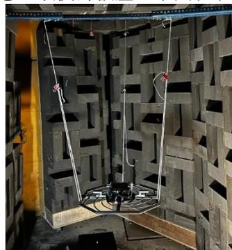
圖 20、平板聲源實驗之麥克風陣列吊掛方式
