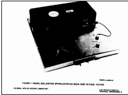
圖 12. 旋轉梁疲勞試驗機台
