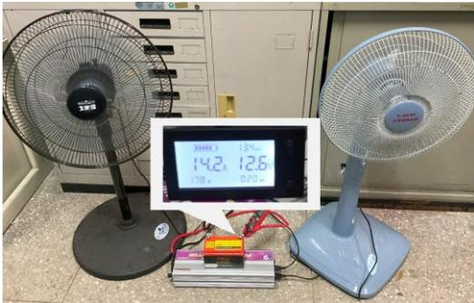
圖 10 電風扇電校號電流示意圖
