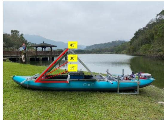
圖 8 太陽能板架設角度示意圖
