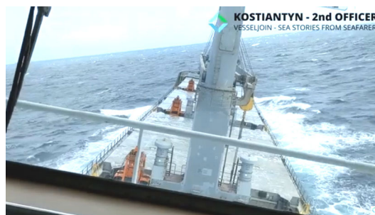
圖 1. 波浪造成船舶橫搖引發散裝船傾斜之情況 (資料來源：2nd Officer KOSTIANTYN POGORELTSEV - Seafarer Profile)
